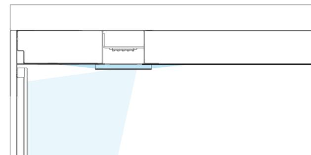
Vertikalschnitt Decke mit integrierter LED-Leuchte und aufgesetzter Filterscheibe, Leuchtrahmen und Blende.
