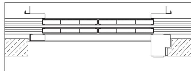
Horizontalschnitt Tür zentral öffnend / Servicezarge.
