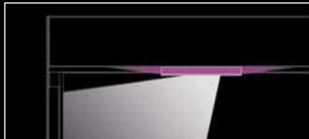
Vertikalschnitt LD7-LED-RGB-Wandfluter. Funktionsschema Direkt- und Indirektbeleuchtung.
