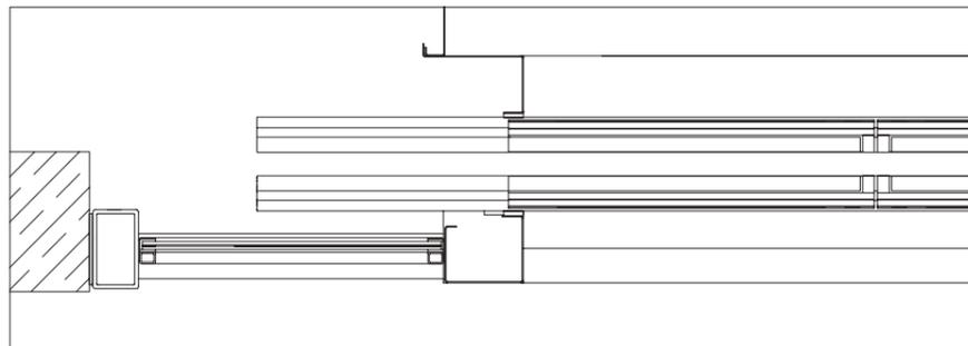
Horizontalschnitt Kabinen- und Schachttür.
