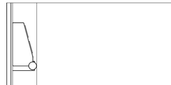
Vertikalschnitt Seitenwand, Bedientableau EN 81-70-B.
