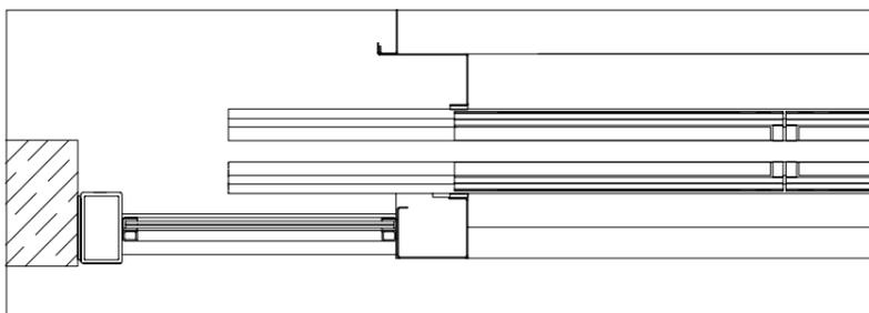
Horizontalschnitt Kabinen- und Schachttür,
